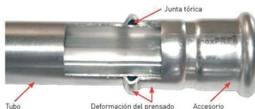
Fig. 2a - Unión prensada.
